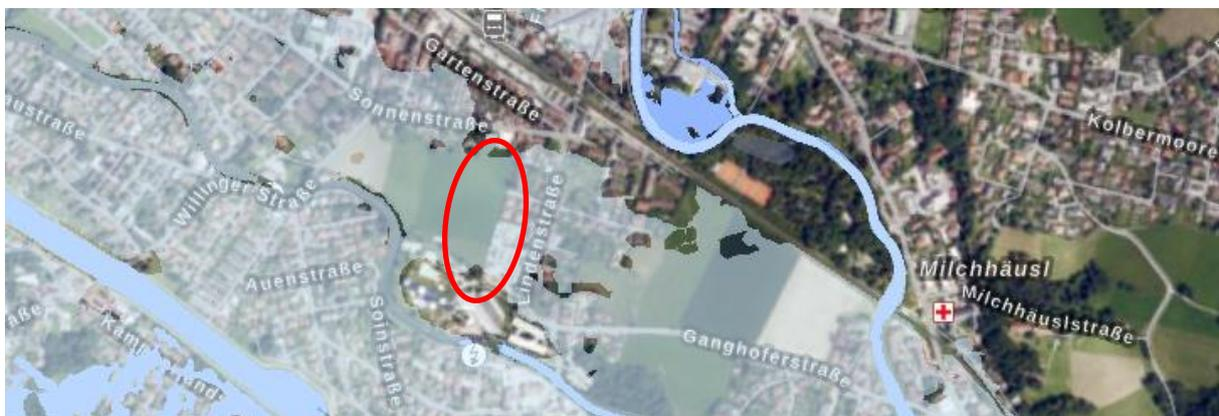
Abb. 15 Darstellung der HQ100 Flächen (schematisch blau) und der Hochwassergefahrenflächen HQextrem (weißliche Flächensignatur) mit Kennzeichnung des Planungsgebiets (schematisch rot umrandet) – o. Maßstab
