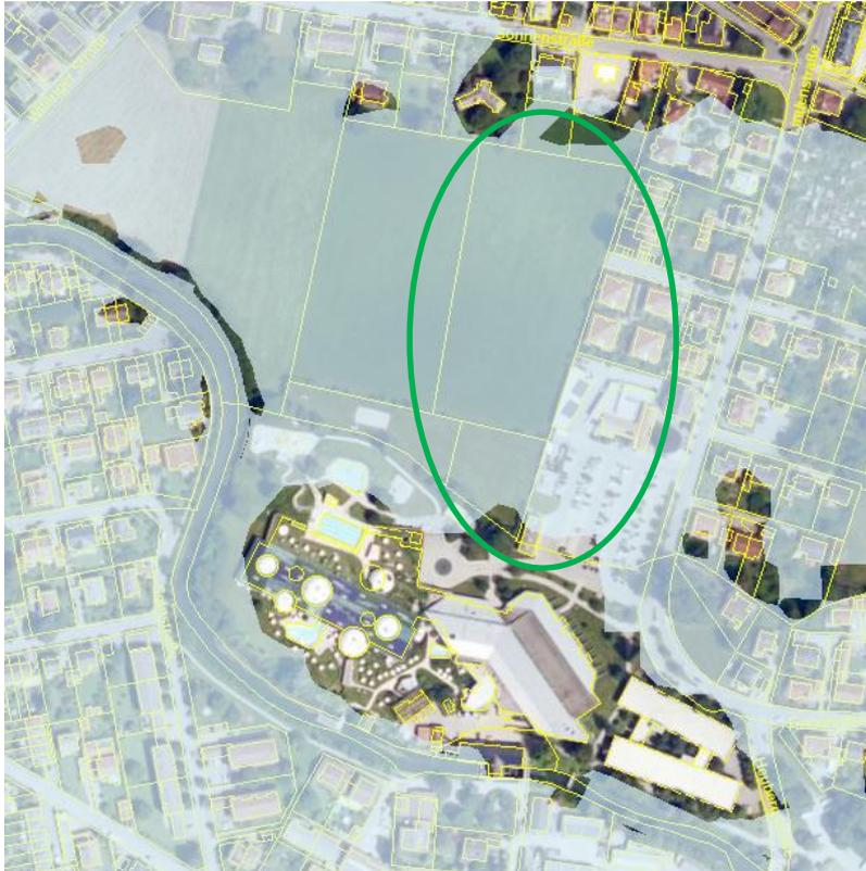
Abb. 5 Hochwassergefahrenfläche HQextrem mit Plangebiet (grün, schematisch) – ohne Maßstab
